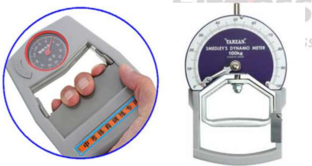
Imagen 8: distintos modelos de dinamómetros para la medición de la Fuerza de prensión isométrica
